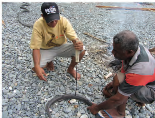
Dari kiri ke kanan: besi cor yang dipanaskan untuk melubangi ban bekas; proses melubangi ban; meyambung ban bekas
