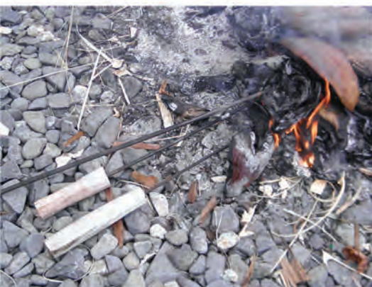
Dari kiri ke kanan: besi cor yang dipanaskan untuk melubangi ban bekas; proses melubangi ban; meyambung ban bekas
