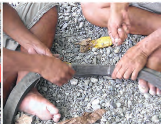
Dari kiri ke kanan: besi cor yang dipanaskan untuk melubangi ban bekas; proses melubangi ban; meyambung ban bekas
